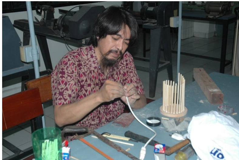
Gambar 10: Proses Instalasi Fitting dan Kabel Lampu (Sumber: Dokumentasi Peneliti)
