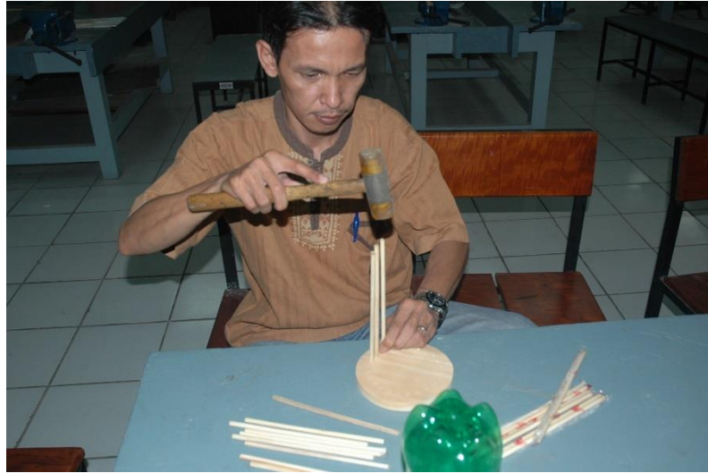
Gambar 9: Proses Pemasangan Sumpit Bambu Sebagai Kerangka Lampu (Sumber: Dokumentasi Peneliti)
